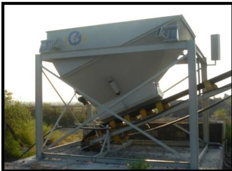
*-Báscula para cemento con capacidad de 3 toneladas con compuerta neumática, celdas de carga electrónicas.*
