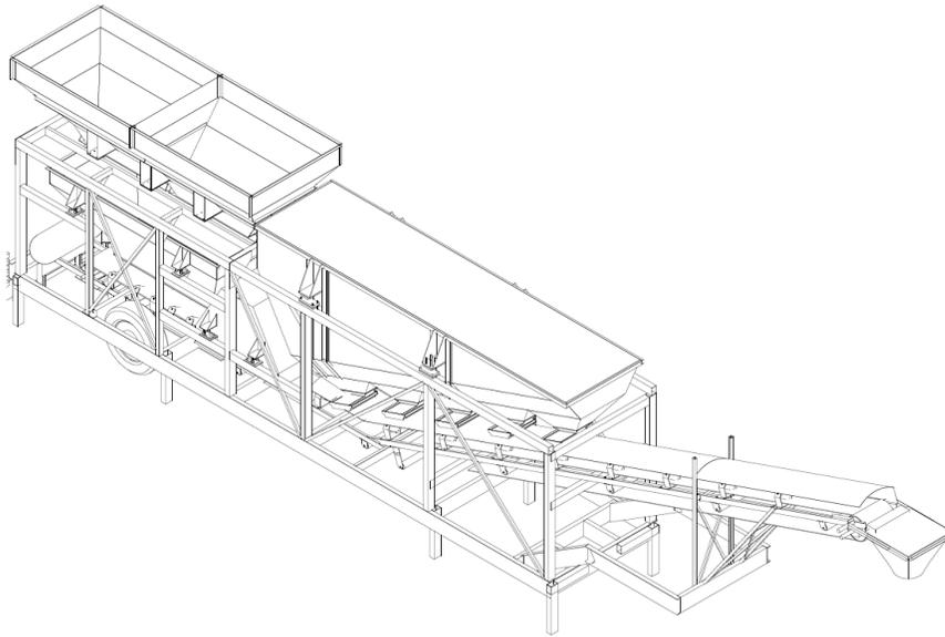
Dosificadora de concreto móvil con capacidad de 45 m<sup>3</sup>/h.
